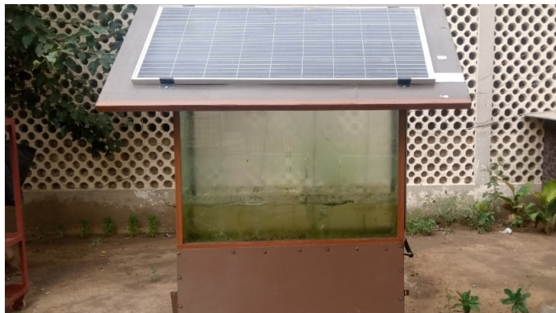
Figura 2. Fotobiorreactor urbano diseñado y fabricado localmente.
